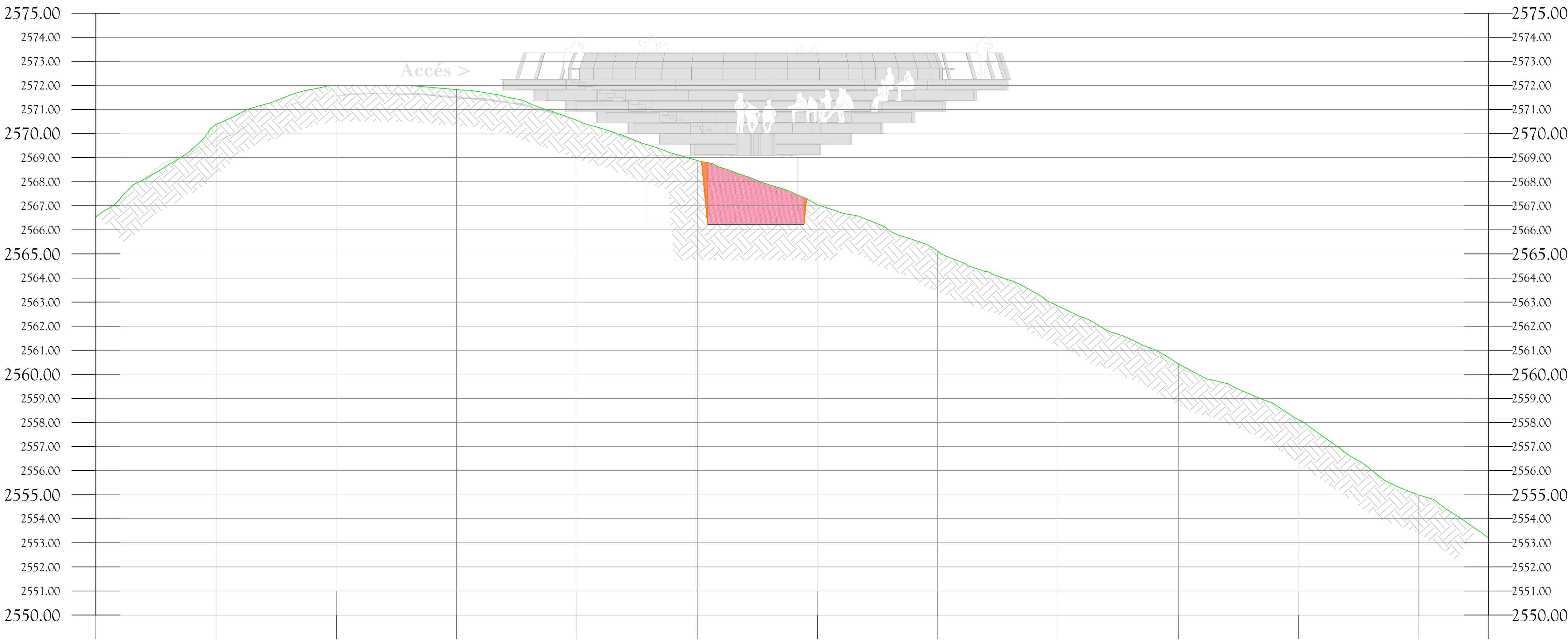
PLÀNOL SECCIÓ EXCAVACIÓ A-A' Escala 1/100
